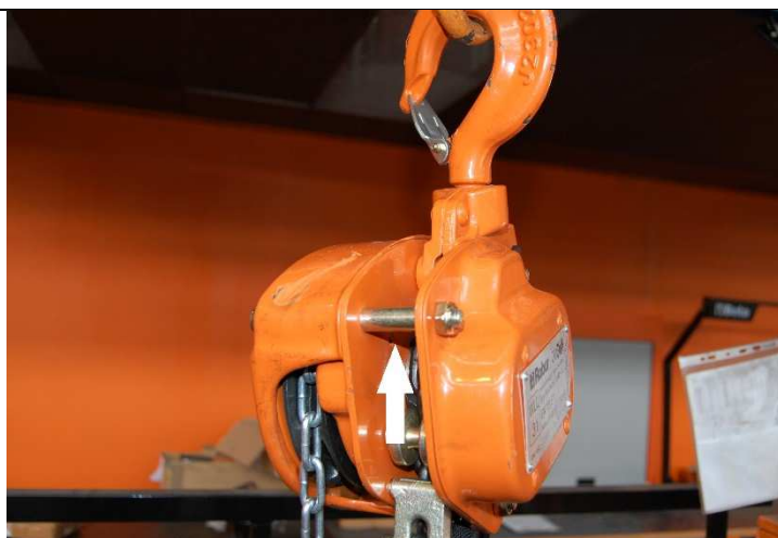
Punto di ancoraggio lato lungo della sacca. (Punto ancoraggio 1).
